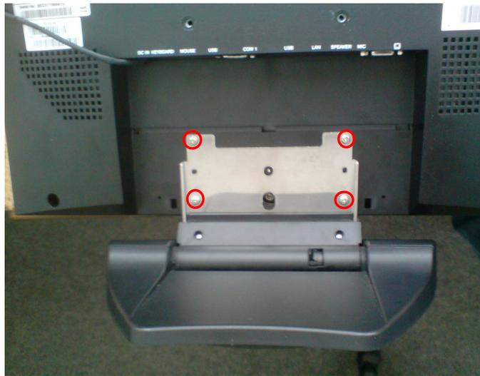
Als letztes müssen Sie nur noch den Standfuß auf der Rückseite mit dem eben eingesetzten Blech verschrauben (Schrauben liegen ebenfalls bei) und die Montage ist beendet.
